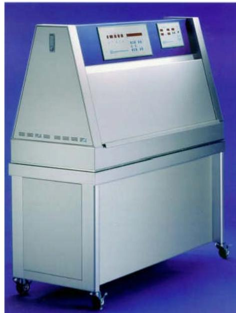
Bild 7: Prüfgerät für künstliche Bewitterungstests QUV / UV-B
