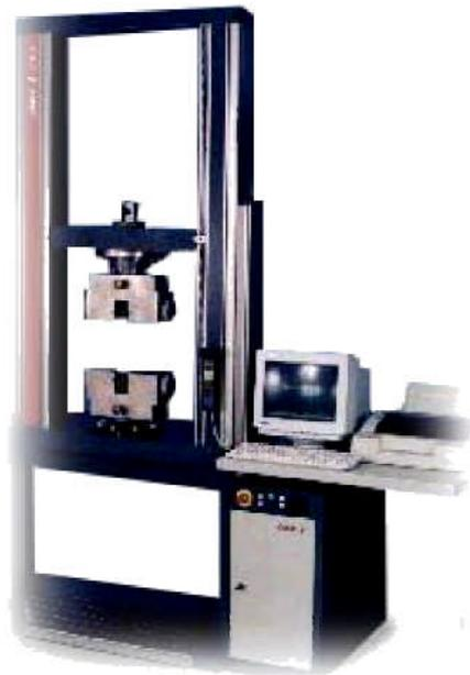
Bild 6: Prüfgerät für Zug- und Biegespannung
